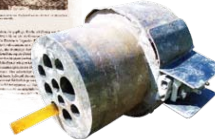
«Свежий» образец прессованного янтаря, полученный на базе лаборатории ремесленного комплекса Куликово. Лето 2011 г.
